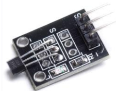
Halleffekt-sensor - måler magnetfelt
